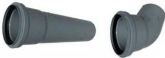
По сравнению с ПВХ трубами полипропиленовые менее жесткие, в свою очередь ПП трубы обладают большей теплостойкостью и могут работать при температуре до 80 С. Поэтому их область применения это внутренние канализационные сети. Так же следует отметить что полипропиленовые трубы плохо горят.
